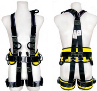
Harnais - ceinture équipé de **quatre points d'amarrage**: dorsal, double sternal : sécurité, évacuation, lateral. Ceinture flexible et légère. Bretelles en **sangles élastiques**. **Large sous-fessier réglable** et adaptable à la morphologie de l'utilisateur. **Boucles automatiques en duraluminium** avec réglage rapide. EN 361 EN 358
