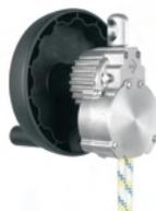
Descendeur automatique avec treuil manuel, vitesse de descente fixe - 0,8 - 0,9/s. Permet ajustement de la position vers le haut. Utilisation : descente, évacuation. max. 1 personnes, charge max. 150kg, hauteur max 150m
