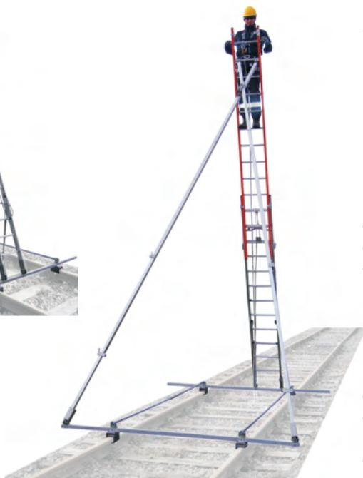
Échelle équipée d'un chariot permettant de déplacer la plateforme sur les voies ferrées, de la fixer et stabiliser. Vous pouvez utiliser l'échelle sans l'appui sur aucune construction solide, et en même temps permettre un travail en toute sécurité sur une échelle bien stabilisée avec une protection contre la chute d'une hauteur.
