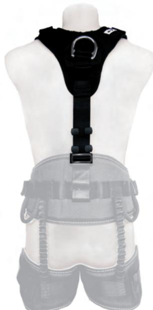
Le torse TOP permet de transformer le harnais cuissard ACTION ONE BELT en harnais d'antichute. Les bretelles en sangle et en mousse sont écartées du tour de cou pour limiter les frottements. En cas de charge sur la ceinture, elles la répartissent sur les épaules.
